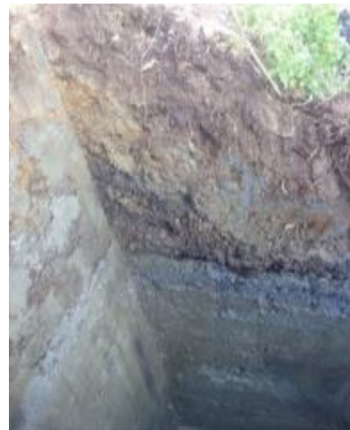
Foto di dettaglio dei depositi di acqua calma limosi-argillosi con intercalazioni di torba.
