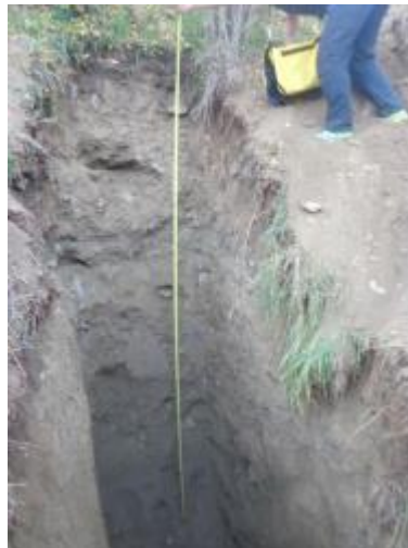
Il saggio 8 nei pressi del rilevato in materiali di riporto alto 8 m nel area abitata di Sluderno
