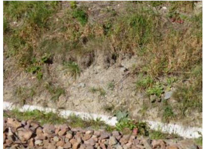
Detailfoto kiesiger und schwach schluffiger Sande (Murschutt) im Erosionsanschnitt (ca. km 74,7).
