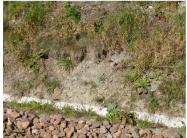
Foto di dettaglio delle sabbie ghiaiose e debolmente limose (deposito di debris flow) presso il taglio erosivo (km 74,7 ca).
