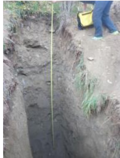
Schurf 8 im Bereich des 8 m hohen Dammschüttungskörpers im Ortsgebiet von Schluderns.
