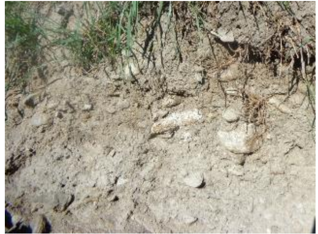
Detail Aufschluss (Böschungsanschnitt) mit sandigen Kiesen (Talalluvionen).
