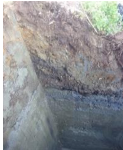
Detailfoto der schluffig-tonigen Stillwasserablagerungen mit Torflagen.
