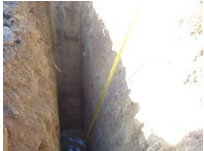
Alluvioni a grana fine nel saggio esplorativo aperto S5.
