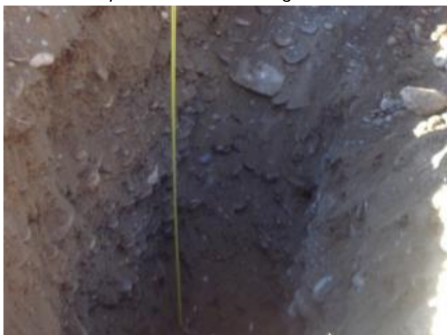
Dettaglio dell'affioramento (saggio S2) con sabbie ghiaiose (alluvioni a grana grossa).
